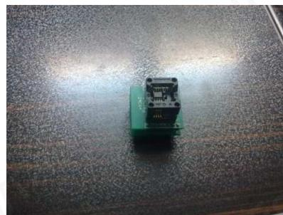
شکل (۳۲-۴) زیف یا سوکت قرار گیری آی سی EEPROM
